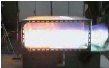
④プラスチックシートが破れ、火炎が外部に噴出する。
