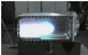
③内圧が上昇し、プラスチックシートが破れ始める。
